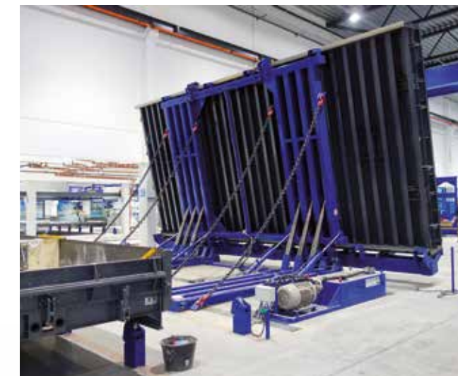
Stație de recepție cu stație de basculare
