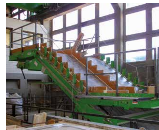
Cofraj pentru scări - fabricare pozitivă
